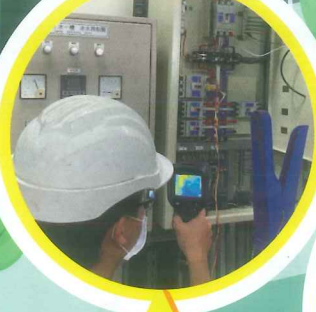
電力盤熱點量測
